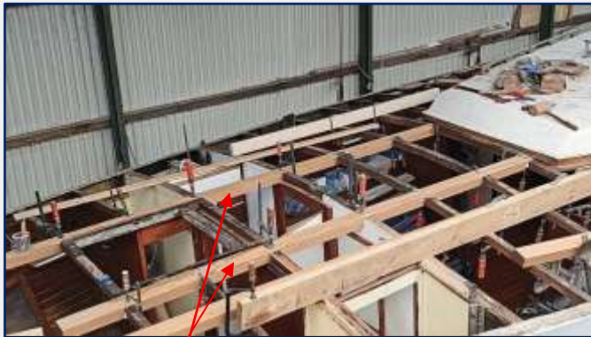
2 langsspanten vastgelijmd in de klemmen
