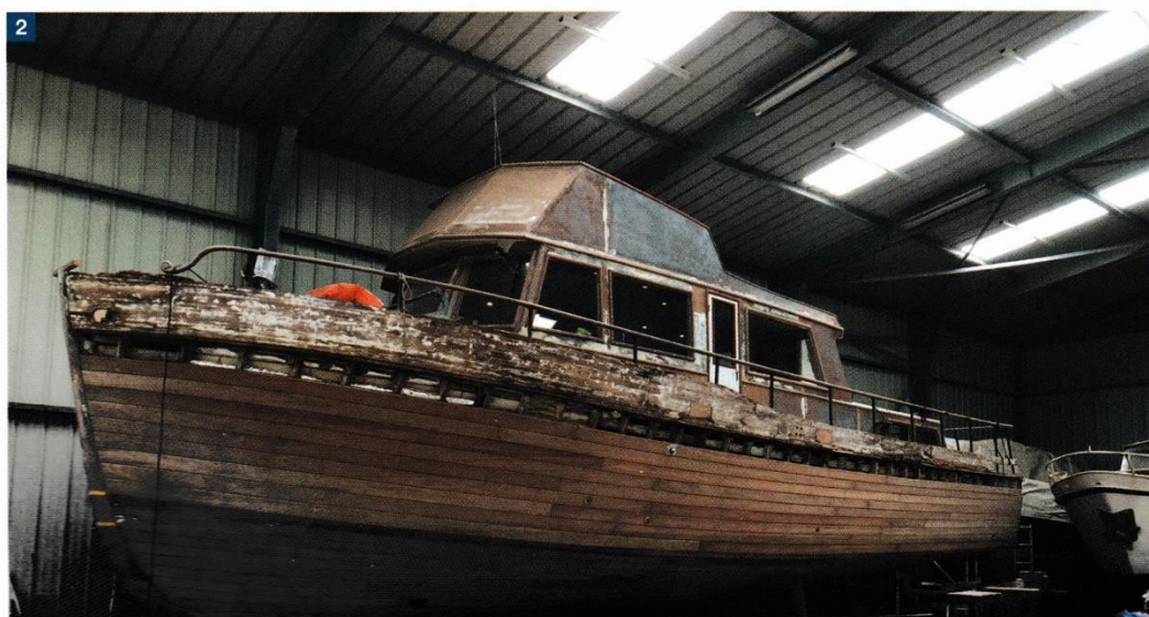
1 De Grand Boys in de haven van de Groninger Motorboot Club. 2 Kaalgehaald in de loods; de bovenste huidgang is verwijderd.
