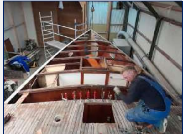
4-kante gat is waar de mast stond
