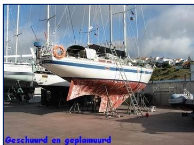
Geschuurd en geplamuurd
