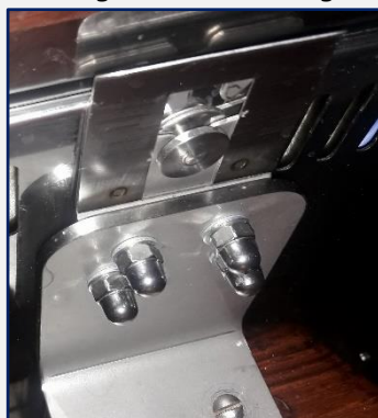
Het fornuis hangt op zijn nieuwe plek cardanische ophanging fixatie op steun
