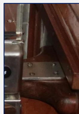
Het fornuis hangt op zijn nieuwe plek cardanische ophanging fixatie op steun
