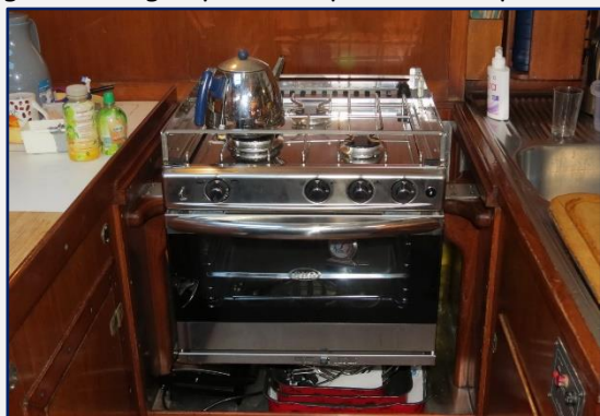
Het fornuis hangt op zijn nieuwe plek cardanische ophanging fixatie op steun
