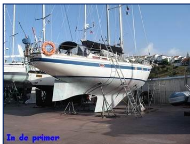
Geschuurd en geplamuurd
